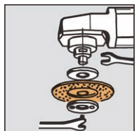
Maschinen-Direktbefestigung Direct attachment to machine Fixation directe sur la machine
